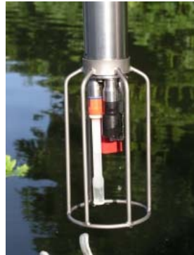
Abbildung 2.3: CTD-Sonde zur Messung von Leitfähigkeit, Temperatur, Druck sowie Sauerstoff- und Chlorophyllgehalt ( http://www.hydromod.de/lake-jewel/de/messung/ctd.html )
