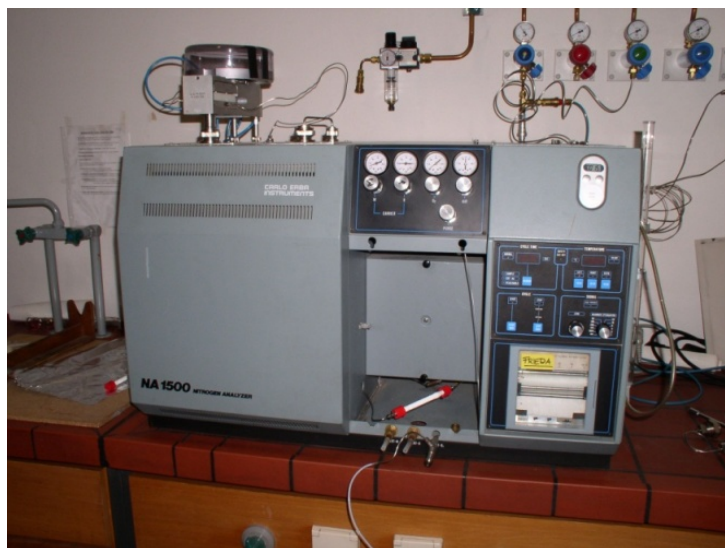
Abbildung 2.2: CHN-Elementaranalysator des IfBM, Universität Hamburg (Quelle: Foto)
