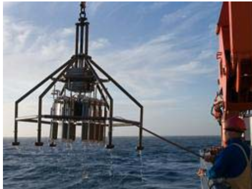
Abbildung 2.1: Multicorer im Einsatz bei einer Forschungsfahrt (Quelle: www. marum.de )
