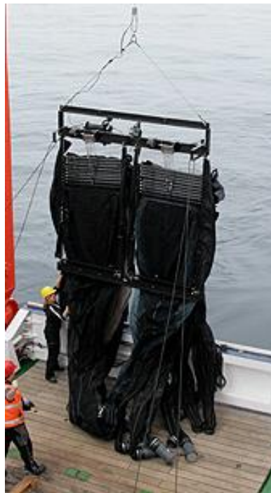
Abbildung 4: 1m 2 Doppel-MOCNESS mit 2*9 parallel verlaufenden Netzen und einer Maschenweite von 333 µm. Abbildung modifiziert nach Dr. Volker Mohrholz (2013; Internetquelle 1)
