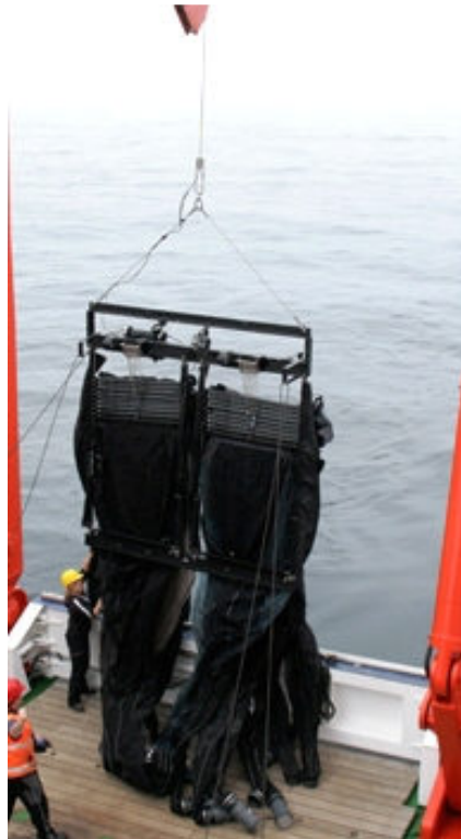
Abbildung 8: MOCNESS am Kran. 2x9 parallel verlaufende Netze mit einer Maschenweite 333 \mu\text{m} , Öffnung 1 \text{m}^2 . Modifiziert nach Dr. Volker Morholz (2013; Internetquelle 3).
