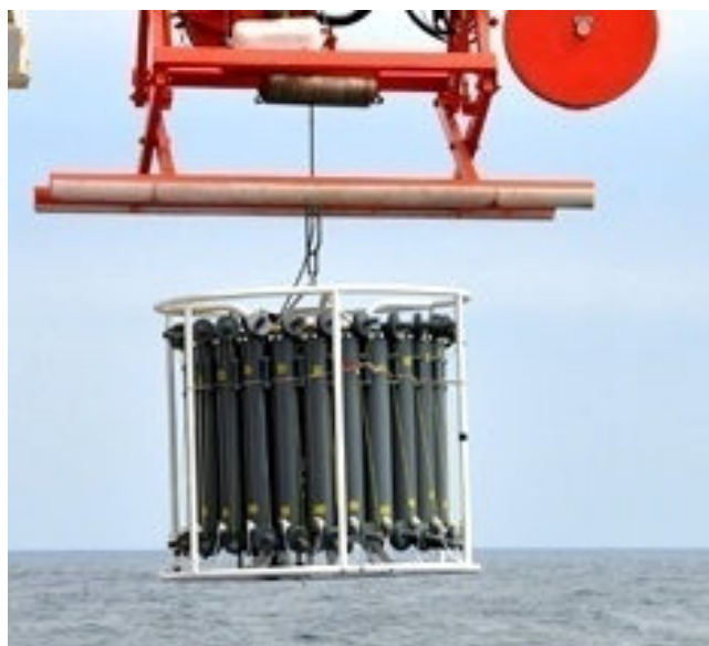
Abbildung 6: CTD Rosette am Kran vor dem zu Wasser lassen. Modifiziert nach André Eckhardt (2013; Internetquelle 3).
