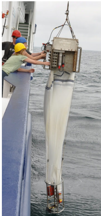
Abbildung 7: Multischließnetz. Öffnung 0,25\text{ m}^2 , Maschenweite 55\text{ }\mu\text{m} . Insgesamt 5 Netze die in definierten Tiefen geöffnet und geschlossen werden können. Bild modifiziert nach André Eckhard (2013; Internetquelle 3)
